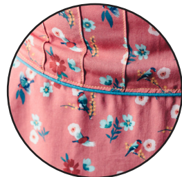
Surpiqûre machine à 2 mm de la couture
